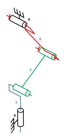
Question 4: Proposer les liaisons planes associées aux liaisons réelles afin de modéliser le mécanisme en plan.
